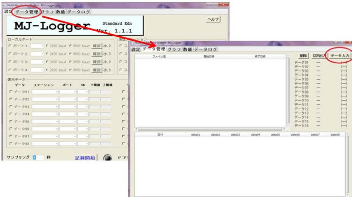
④データ記録された SD カードを PC に挿入します。 SD カード内のフォルダを指定し、必要なデータファイルを選択します。
