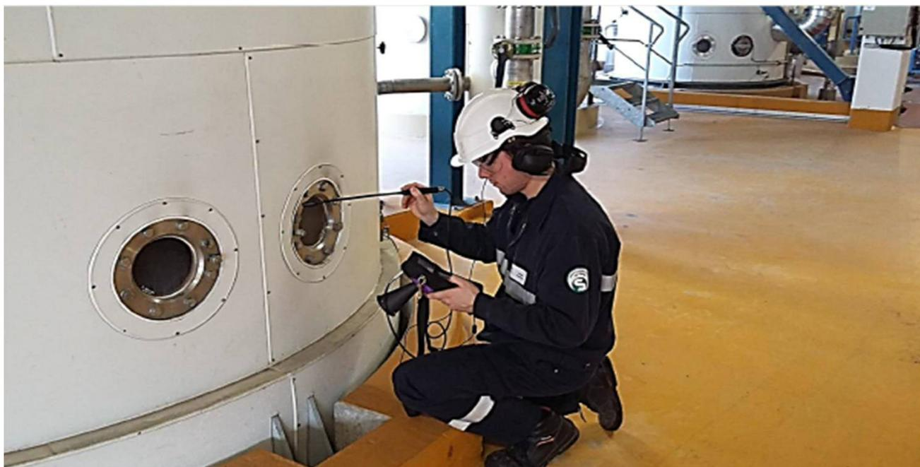
写真↑ : リークカメラMJ-LKSを使用して『食物乾燥機の真空漏れ』を測定
