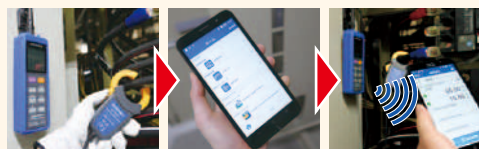
CM7291とセンサを接続し測定部に設置 タブレット上で専用アプリ GENNECT Cross を起動 測定結果を無線でタブレットに送信
