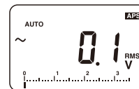
300.0V レンジでは 0.1V の桁が最小桁となります
