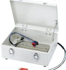
高絶縁抵抗の試料や、誘導性または容量性の試料の測定時に試料収納箱として用い電磁遮蔽を行います。分銅電極SME-8320と組み合わせ使用時には、対電極またはガード電極ともなる電極があります。コンデンサやトランス等の電子部品測定時にも外部からの雑音、漏洩電流などを防止して安定した測定が可能。※DSM-8104と組み合わせて使用する場合は別途インターロック接続ケーブル(DSM8104F)が必要です。
