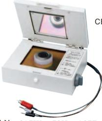
平板試料の固有抵抗測定用電極。試料のサイズは40 mm角から100 mm角、厚さ8 mmまでの測定が可能。主電極は直径19.6 mm, ガード電極は内径24.1 mm, 外形28.8 mmです。外観及び使用方法は、SME-8310と同じ。※DSM-8104と組み合わせて使用する場合は別途インターロック接続ケーブル(DSM8104F)が必要です。
