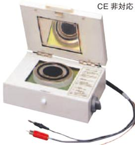
平板試料の固有抵抗測定用電極。試料のサイズは100 mm角、厚さ8 mmまでの測定が可能。主電極は直径50 mm, ガード電極は内径70 mm, 外形80 mmです。インターロック接続ケーブルで本体と接続すると、蓋が開放状態では測定電圧は「OFF」となります。体積抵抗と表面抵抗の切換えはサイドスイッチでおこなえます。※DSM-8104と組み合わせて使用する場合は別途インターロック接続ケーブル(DSM8104F)が必要です。JIS K6911に準拠
