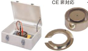
遮蔽箱(SME-8350)と組み合わせて使用する平板試料用の電極。カーペットなどの粗い面の試料でも、表面抵抗及び体積抵抗の測定が簡単におこなえます。主電極は直径50 mm, ガード電極は内径70 mm, 外形80 mmで両電極の同心円を構築する治具付き。
