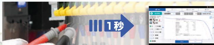
電圧の検出で測定を開始、多点測定作業がスムーズ。
