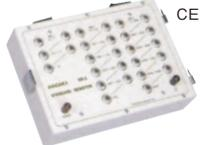
超絶縁計用の校正抵抗箱。超絶縁計本体と確実にガードが取れる構造を採用。最高使用電圧: DC1,000 V。抵抗: 10 ~ 10,000 M $\Omega$  (24点構成)
