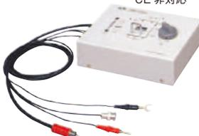
チップコンデンサの絶縁抵抗測定用電極。治具は0 mmから11 mmまで任意調整でき各種チップコンデンサの測定が可能。インターロック接続ケーブルで本体と接続すると、蓋が開放状態では測定電圧は「OFF」となります。※SM-8220sで使用する場合はインターロック接続ケーブルの改造が必要です。
