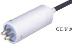
樹脂の成形品、ゴムの加工品等のように形状が曲面である場合や試料が小さい場合に使用できる表面抵抗測定用電極。電極先端を試料に押し付けるだけで、簡単に表面抵抗の測定が可能。電極間隔は10 mmで $10^{11} \Omega$ までの抵抗測定が可能。
