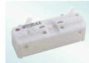
SMD テストフィクスチャ 9677 直結型, 側面に電極がある SMD 用, DC ~ 120MHz, 試料寸法: 3.5 ± 0.5mm ..... ¥107,000
