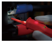
照明用 LED ライト / コンパレータ判定表示 (緑 LED) 付きの手足スイッチ付きテストリード L9788-10
