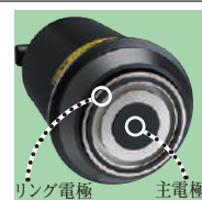
体積抵抗測定 上部電極の主電極と体積抵抗測定用対電極に挟まれた試料の体積抵抗を測定します。
