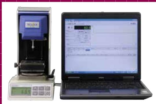
Oリングや小物ゴム部品、薄いゴムシートなどの硬さを測定するために規定されているのがIRHDマイクロゴム硬さ計です。
