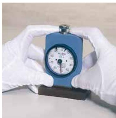
手押しによる硬さ測定は、デュロメータを真上から測定物に押し当て、加圧面を密着させて値を読み取ります。
